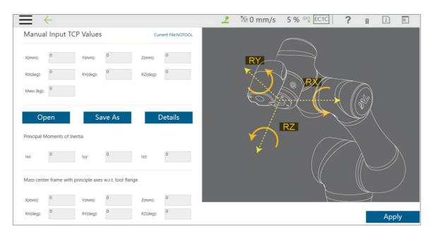
Figure 112: Manual Input TCP Values
